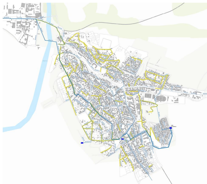
ФИГУРА 5-10: ВОДОСНАБИТЕЛНА МРЕЖА НА ГР.БЯЛА
