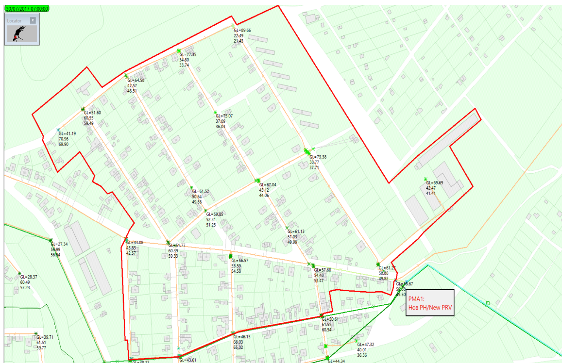
Фигура 10-15: Нов регулатор на налягане - PRV 1 и зоната която водоснабдява
